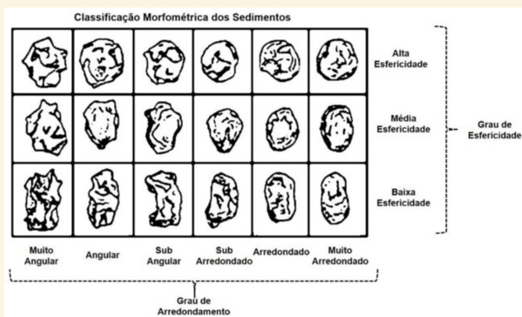
Figura 14 - Escala de esfericidade e arredondamento dos sedimentos. Adaptada de Powers (1953).
