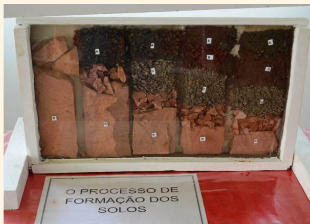
Figura 17 - Exemplo de maquete simples que pode ser construída em sala de aula para demonstrar o processo de formação do solo e diversificação dos horizontes.
