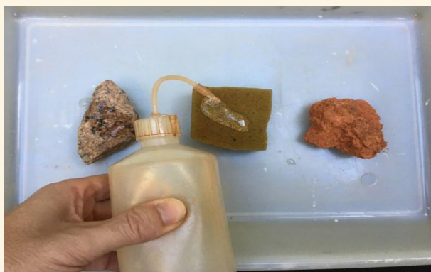
Figura 18 - Experimento de absorção de água em três tipos diferentes de material (da esquerda para a direita): fragmento de rocha, esponja e agregado de solo.
