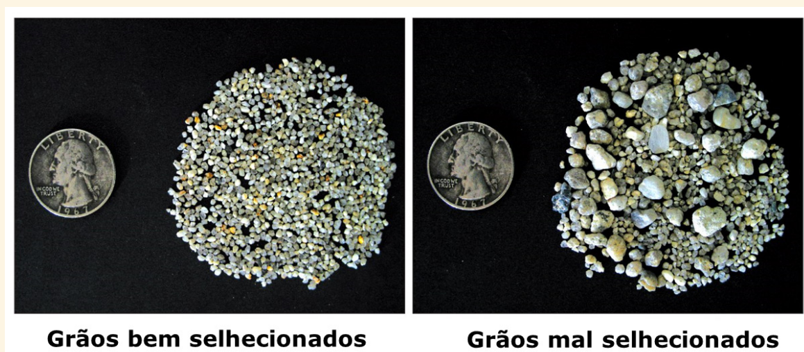
Figura 16 - Exemplo de conjunto de sedimentos bem selecionados (esquerda) e mal selecionados (direita).
